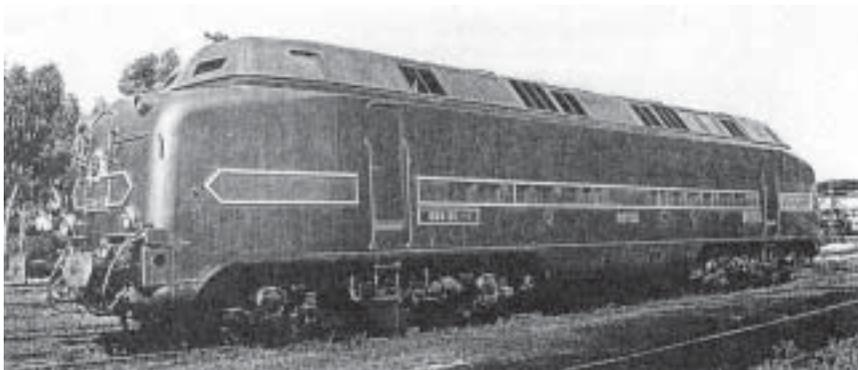
*Una de las 37 Alsthom argelinas, con el blindaje en el techo para defender a la tripulación de los atentados.*
