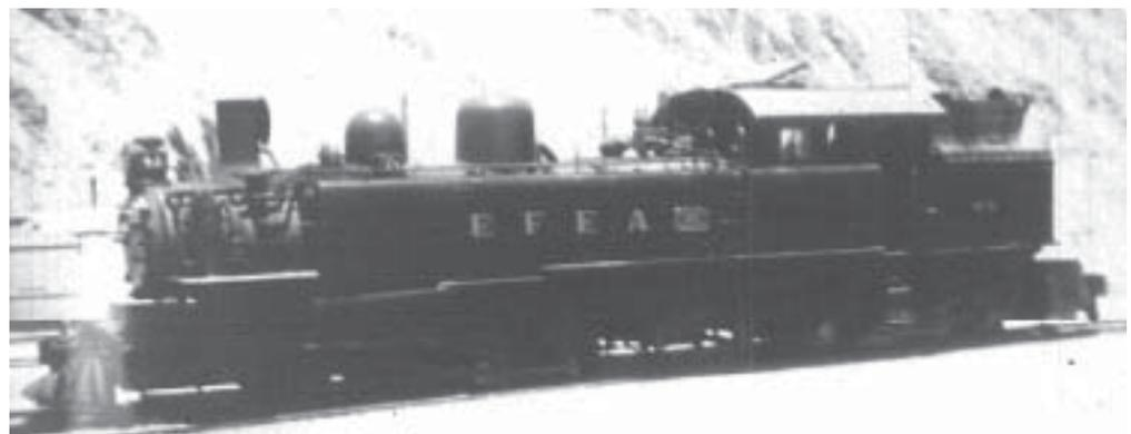
Ambos bastidores funcionaban a manera de bogies, sobre los cuales se articulaban los demás elementos de la locomotora.
