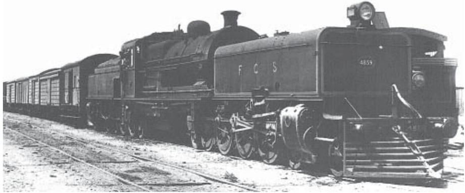
Locomotora Garratt del FCS de la clase 14 en la playa de Kilo 5 partiendo con un tren de carga.
