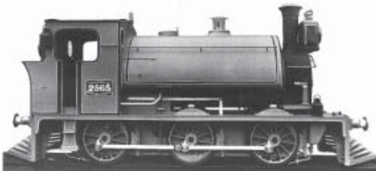
Las locomotoras del tipo Saddle Tank, fueron muy comunes en los Ferrocarriles Buenos Ayres al Pacífico y Central Argentino.
